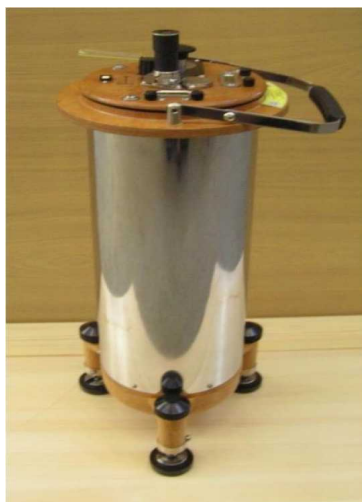
Рисунок 15. Общий вид гравиметра наземного узкодиапазонного с кварцевой чувствительной системой класса «В» ГНУ-КВ. Источник изображения: описание типа ГНУ-КВ № 50841-12 [15, рис. 1, л. 2].
